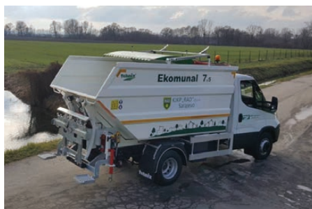
Tehnix podizač kanti i kontejnera od 80 do 1100 litara
