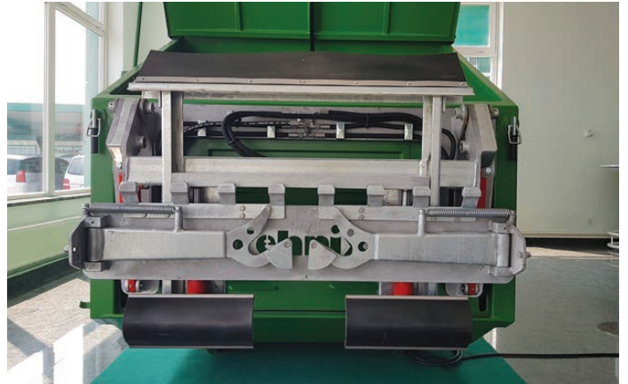
PODIZAČ ZA KONTEJNERE od 120 do 1100 l LIFTER FOR CONTAINERS from 120 to 1100 l
