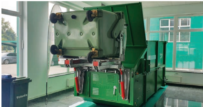
PODIZAČ ZA KONTEJNERE od 120 do 1100 l LIFTER FOR CONTAINERS from 120 to 1100 l
