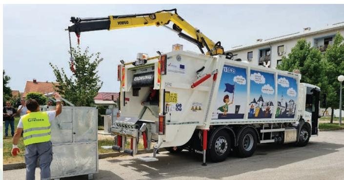
ECONIC - niskopodno vozilo s kranom u funkciji
