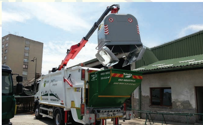
PALFINGER kran u funkciji - zvonasti kontejner
