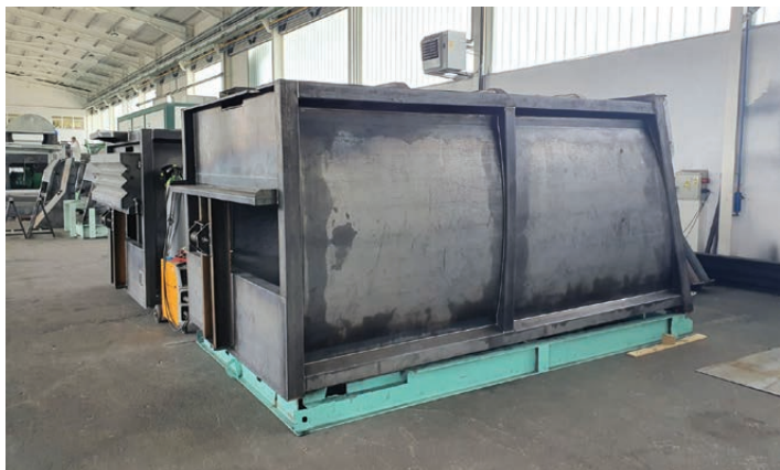
Bazična proizvodnja kostura sanduka nadogradnje
