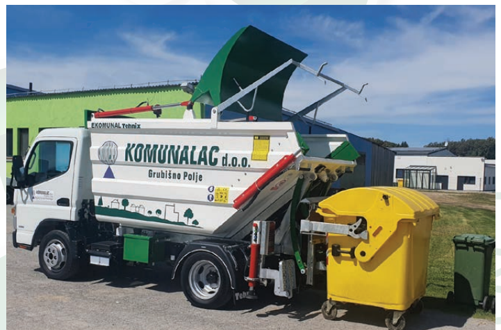
Podizanje PVC kanti i kontejnera
