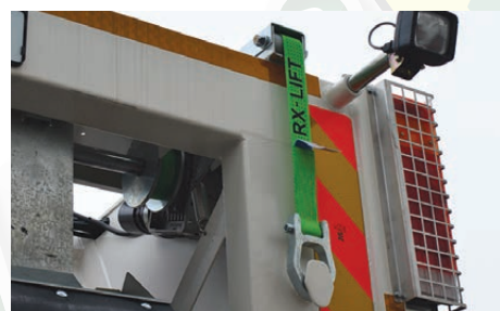
Sustav za podizanje 5-7m³ kontejnera
