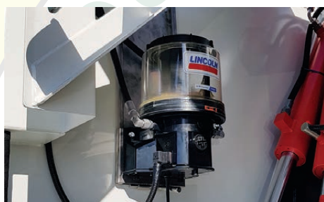
Automatsko podmazivanje kliznih površina
