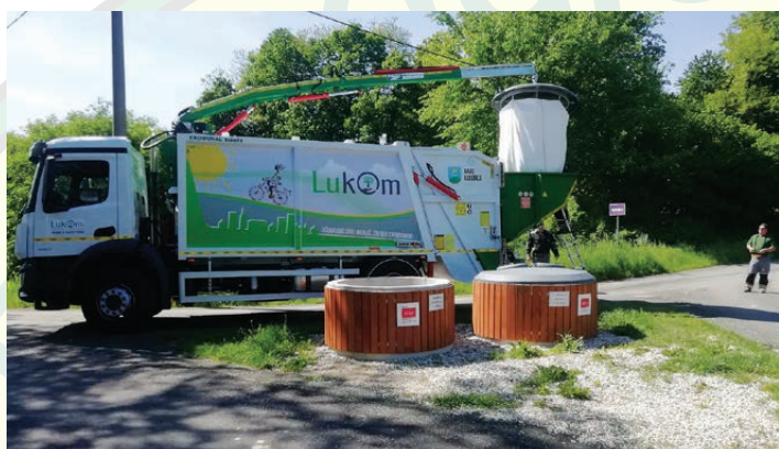
TEHNIX kran u funkciji - podzemni kontejneri
