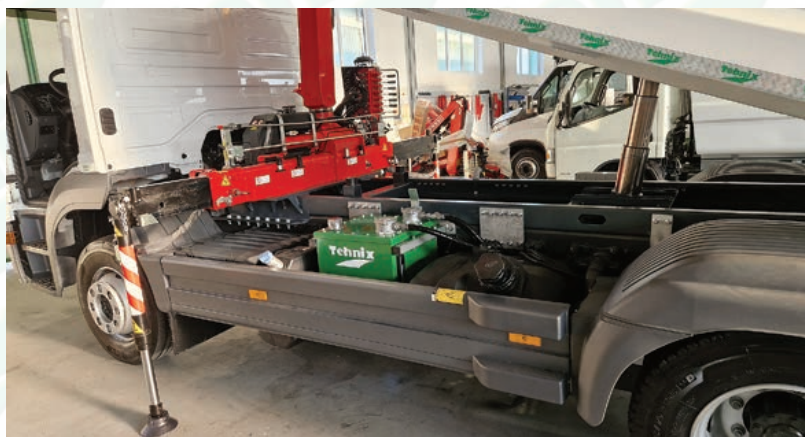
Posebni TEHNIX nastavci - montažno-demontažne stranice
