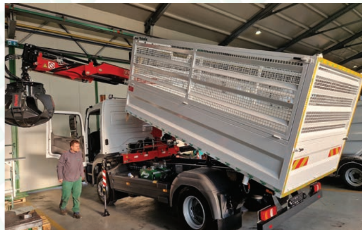
Posebni TEHNIX nastavci - montažno-demontažne stranice
