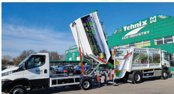
Mogućnost pretovara malih u velika vozila pomoću hidrauličnih produžetaka za potpunu preciznost i dodatnu čistoću
