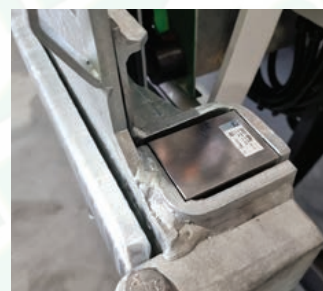
Identifikacijski sustav - RFID i upravljački mehanizam EKOMUNAL nadogradnje
