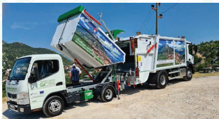
Mogućnost pretovara malih u velika vozila pomoću hidrauličnih produžetaka za potpunu preciznost i dodatnu čistoću
