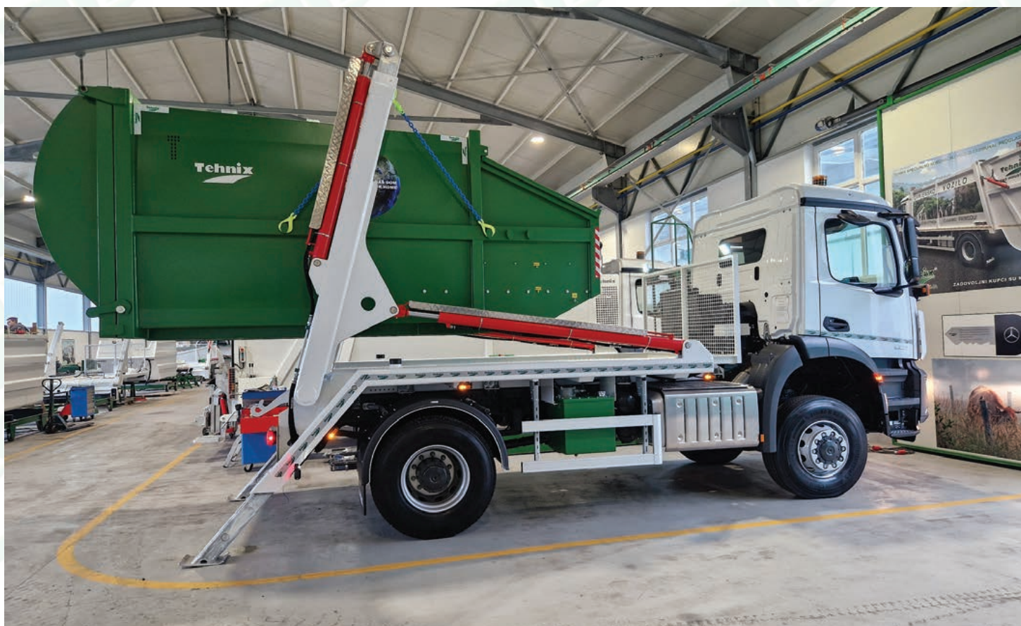
PTP 10 - Podizanje preskotejnera s teleskopskim rukama
