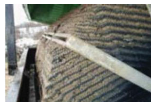
Kolonije bakterija na biološkoj opni biorotora
