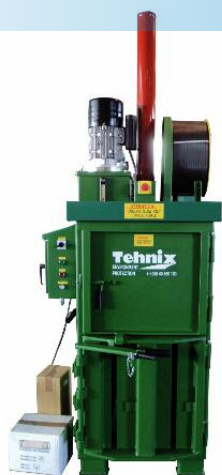
Preša balirka - vertikalna Baling press - vertical
