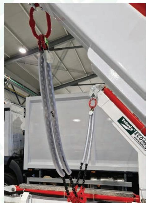
Detalji opreme i zaštita od udaraca lancem
