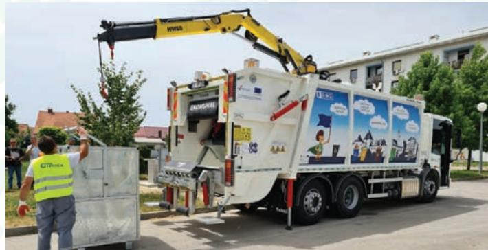
ECONIC - niskopodno vozilo s kranom u funkciji
