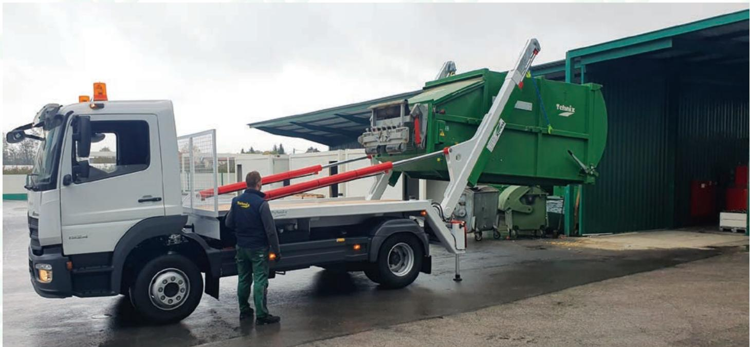
PTP 10 - Podizanje preskontejnera s teleskopskim rukama
