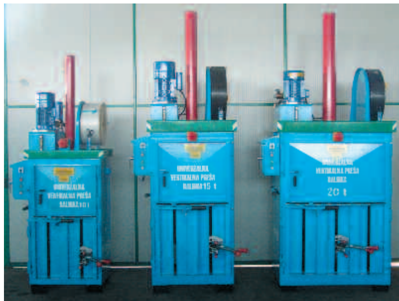
Preša balirka - vertikalna/potisak 10, 15 i 20 t
