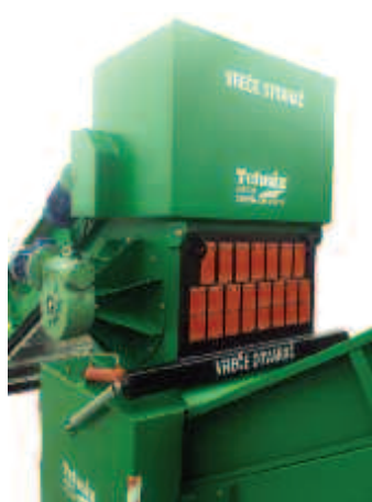
Otvarač vreća tip TEHNIX - kapaciteta od 5 do 20 t/h, mogućnost otvaranja vreća od 5 do 50 kg
