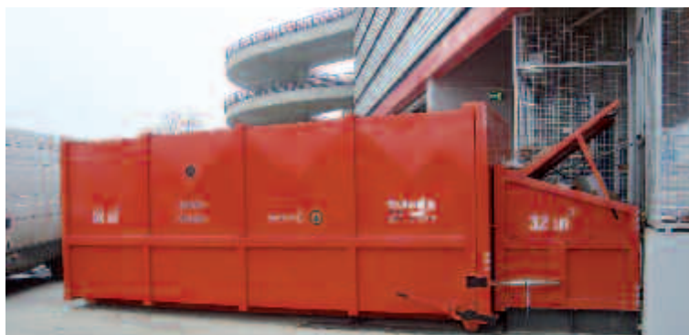
Preskontejneri dvodjelni rolo 32 m 3 , do 10 tona
