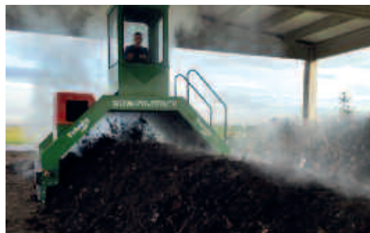
KOMPOSTDER stroj za obradu bio-razgradivog otpada
