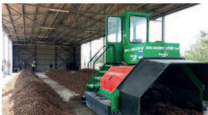
EKO-KOMPOSTER - stroj za obradu drva promjera do 120 mm
