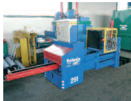
HPB-25 specijalne izvedbe, pritisak prešanja 10 kg/cm 2
