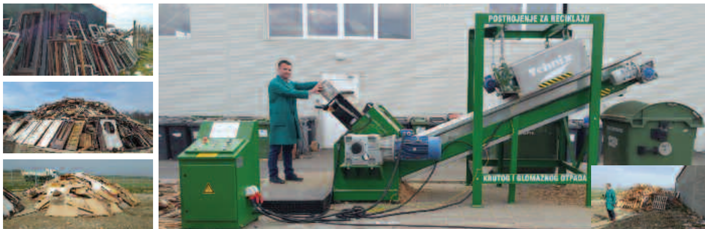
Šreder za usitnjavanje drvenog, plastičnog i gumenog otpada sa elektromagnetom za izdvajanje metalnog otpada
