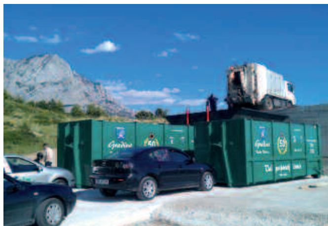
Automatska pretovarna stanica tip Tehnix - iz smečara u preskontejnere 32 m 3
