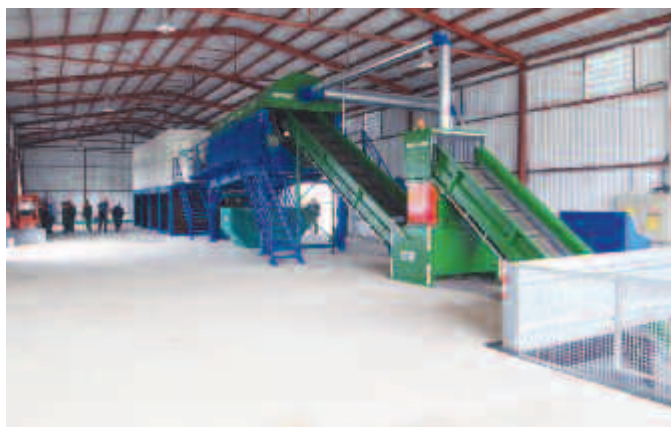
Linija za sortiranje PROGRES - Doboj 5 t/h
