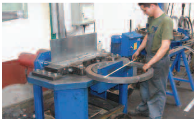
Izrada prirubnica savijanjem na specijalnom stroju
