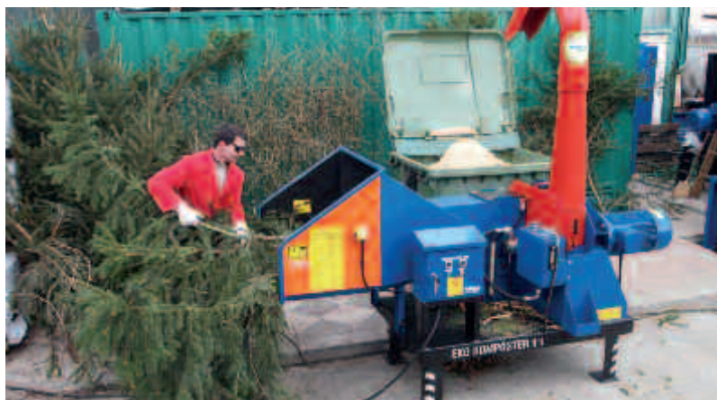
EKO-KOMPOSTER - stroj za obradu drva promjera do 120 mm
