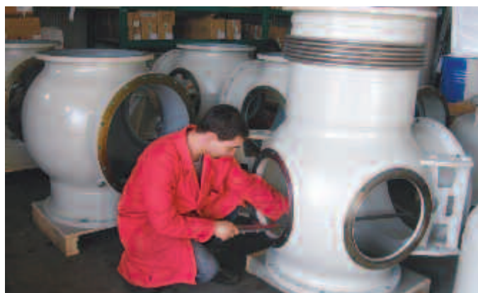
Završna kontrola gotovih kućišta nakon bojanja
