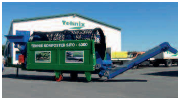
KOMPOST SITO kompaktni uređaj za kvalitetno i brzo prosijavanje
