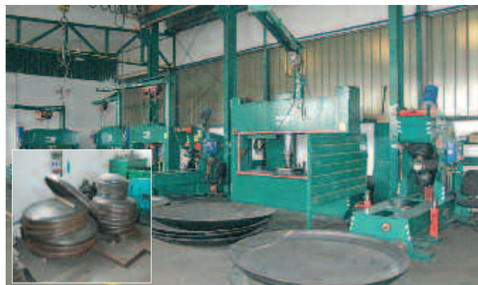
Tehnološka linija Tehnix za proizvodnju podnica debljine lima do 15 mm i promjera od 500 do 3000 mm
