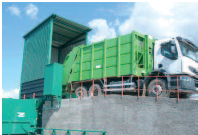
Automatska pretovarna stanica tip Tehnix - iz smečara u preskontejnere 32 m 3
