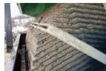
Kolonije bakterija na biološkoj opni biorotora
