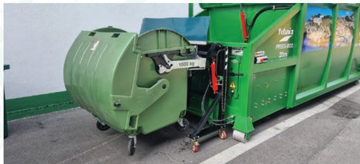
Mobilni podizač za kante i kontejnere - brza hidraulička spojka
