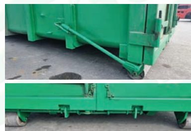
Sigurnosno zatvaranje s mehanizmom za jednostavno otvaranje / zatvaranje
