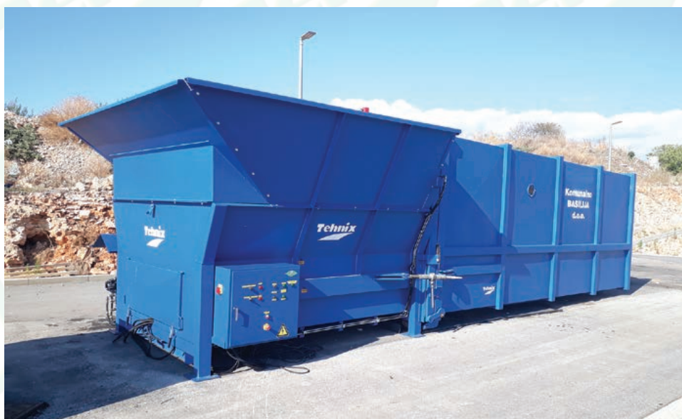
Dvodjelni preskontejner u funkciji pretovarne stanice
