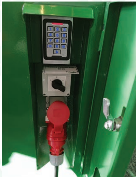
Tehnix preskontejner upravljan s elektronskom ID karticom, otiskom prsta i šifrom
